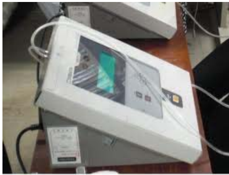
図1 労研式マスクフィッティングテスターMT-03
