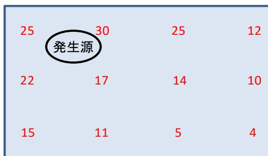
図1.10 A作業場の気中有害物質濃度 (ppm)
