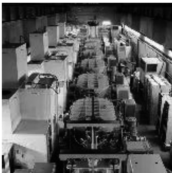
写真1 ニホニウム発見のキーとなった直線型加速器(理研のRilac)(50mの柱のない建屋の中に設置されている)
