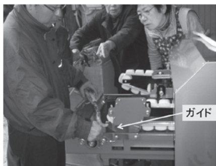
図9 根葉切り機の切断位置決め装置の説明：ガイドの内側が刃の内側の切断位置。ガイドの内側に、根切りの位置を合わせる。
