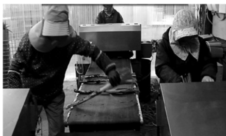
図19 皮むき機に向かって右側の作業者は、体を左に傾けて、左手を伸ばして葉身を掴んで、右手に持ち換えて、皮むき作業をしている。
