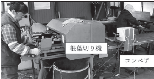
図5 根葉切り作業：根葉切り機と接続されたコンベア
