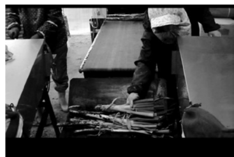
図11-7 移動コンベア内で処理できなかったネギは、受け皿に落下して、一時保管（バッファ）される。作業者は、受け皿に手を伸ばして、ネギを掴み、皮むき作業を行う。
