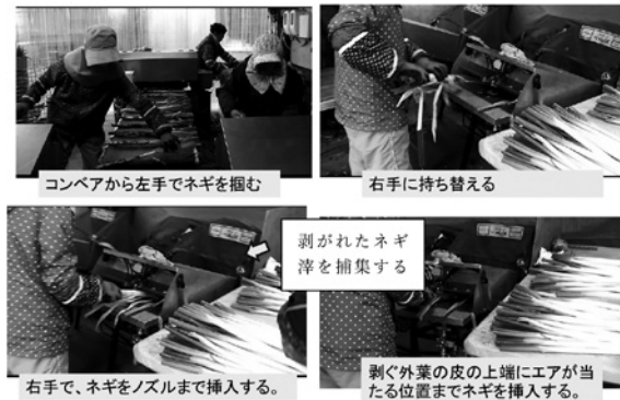
図11-2 皮むき機に向かって右側の作業者：左手で葉身を掴み、右手に持ち替えて、皮むき機に挿入する。
