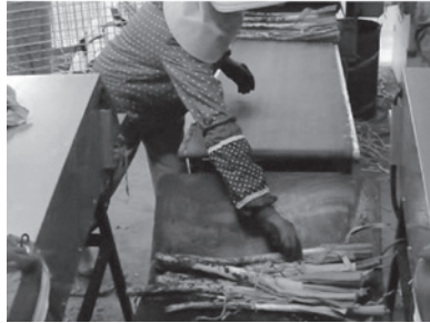
図25 根切り後のコンベアのバッファの位置の改善（横山詔常ら）
