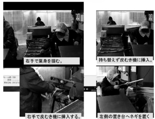
図11-6 左側の皮むき作業者：右手で葉身を掴んで、そのまま持ち替え無しで皮むき機に挿入できる。調整台から離れた置台に処理済みのネギを置く。
