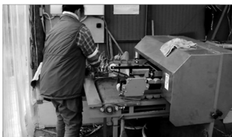
図18 根葉切り作業の配置の問題点：非利き手側の左側にネギ置台があるため、体を捻じって取っている。これを利き手側に配置を変更する。
