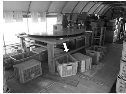
図8-3 小松菜の調製作業の回転テーブルの工夫。
