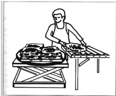
図8-1 水平移動を回転テーブルの回転に置き換える。（ワークデザインp153左側）
