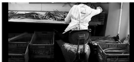
図11-1 葉ネギの調製作業でのコンテナへの収納時の右腕の挙上負担の例。
