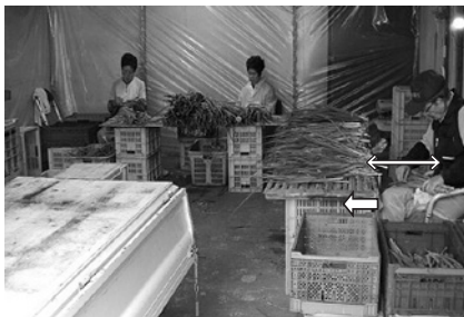
図12-5 コンテナでつかえて、台の下に膝が入らない作業台。ネギと人の距離が遠い→腕の負担が増加，体幹の前屈→膝が入る台の高さが良い。
