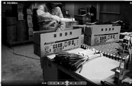
図11-3 段ボール箱の蓋が立っているため、腕の挙上が大きく、負担が大きい。箱の手前の蓋を折り曲げ、腕の挙上を避ける工夫をする。
