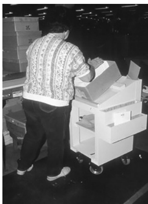
図9-2 作業台を傾斜させて前屈姿勢の改善例 (Konz提供)。
