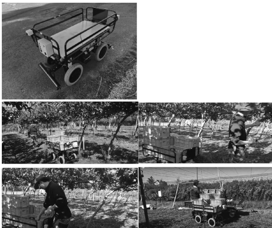
図19-3 人への自動追従ロボット運搬車にコンテナを積む改善。ロボットの前後に搭載されたカメラで人を識別して自動追従する。収穫が終わると、大型運搬車の所に行き、コンテナを積み替える（秋田県農林水産部農林政策課）
