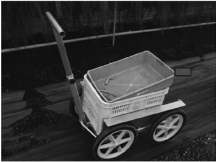
図11－1 収穫用の改良台車：車輪を大きくすることで、ぬかるみなどの運搬をスムーズにする。（広島農業技術センター）
