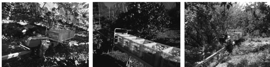
図17-1 ミカン用の動力式モノレール ( https://www.nikkari.co.jp/wp-content/uploads/2022/02/e3c59ae78ba76b3357ec0d82975e1a5b.pdf )
