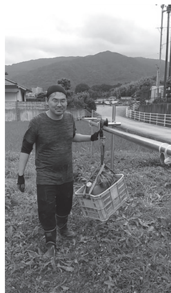
図16-2 圃場でのモノレール運搬装置の実機試験：敷設も容易で、20kgコンテナが容易に運搬可能です。ウド・エルゴ研究所 ユーワークス 宇土昌宏氏製作（お問い合わせ先：ウド・エルゴ研究所 udoergo.jp ）
