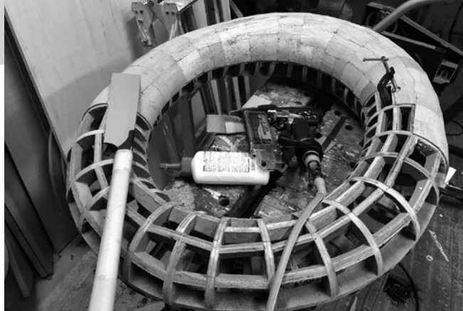
合板を貼り合わせて製作中のドーナツ。12ミリの合板で骨組をつくり、そこに柔らかい合板をひとつひとつ貼り合わせていく（2018年12月自宅作業場にて。撮影・菅沼緑）
