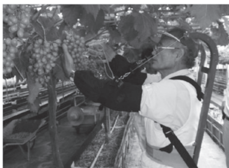
図24-1 アームリフトの装着（バネで肘を吊り上げ、上肢の挙上負担を軽減する。）
