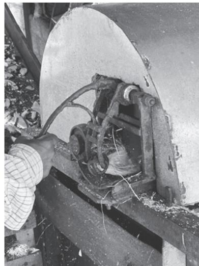
写真4 安全にココナッツ殻を機械に押し込むためにハンドルを付けたフィーダー装置。
