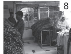
8 十分な換気のためのファンの設置
