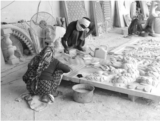
写真2 作業者の小脇には水の入れ物がいつも置かれていています。石の彫刻作成もこまめに水をかけて粉塵発生を抑えながら進めます。
