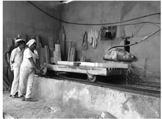
写真3 自分たちでホースを取り付けて水を吹きかけながら石材を切断します。
