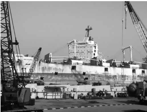
写真1 作業者は船上で船体をブロックに切断していく。
