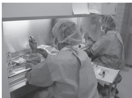
薬剤師・抗がん剤調製の専用室 キャップ・マスク・ガウン着用 生物学的安全キャビネット使用
