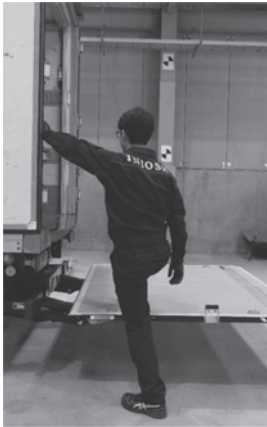
図5 プラットホームを地面と荷台の中間位置で停止させての昇降例
