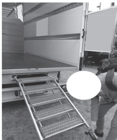
図3 欧州で市販されている引き出し式昇降ステップ
