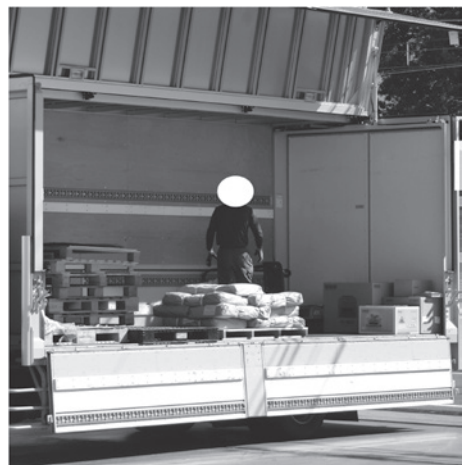
図2 作業者の昇降設備を持たないウイング車
