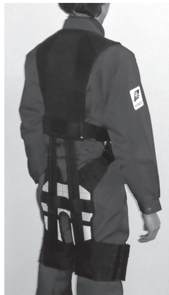
図4 コンブ干し作業用アシストスーツ
