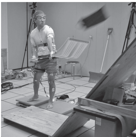
図1 三次元動作解析装置および表面筋電計による除雪動作の計測
