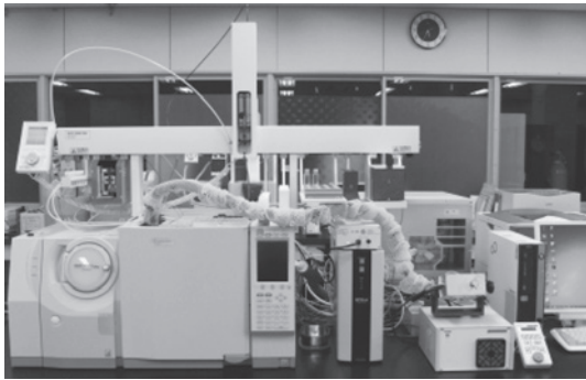
図5 ニオイ分析総合システム（ガスクロマトグラフ質量分析計）
