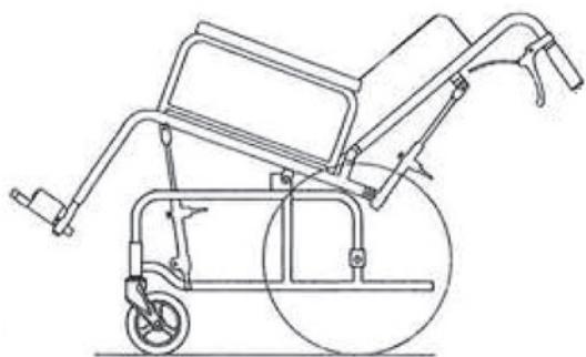
図2 座位変換形車椅子（ティルトおよびリクライニングした状態）
