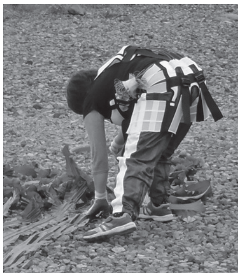
図3 試作アシストスーツを着用してのコンブ干し作業身体負荷計測試験
