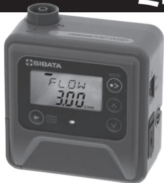
積算流量測定機能、定流量機能を内蔵した携帯型のアサンプリング用吸引ポンプです。設定流量範囲は0.050~5.00L/minと広範囲をカバーしており、個人ばく露測定や作業環境中のエアサンプリングなど幅広く使用いただけます。
