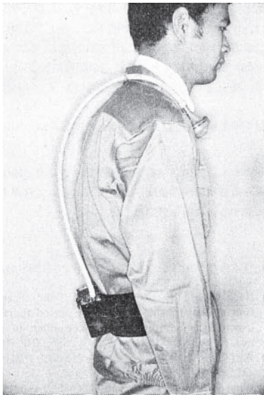
図 労研式粉塵用個人サンプラー（木村 [4] より）
