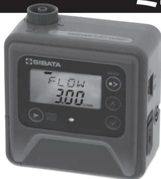
積算流量測定機能、定流量機能を内蔵した携帯型のエアサンプリング用吸引ポンプです。設定流量範囲は0.050~5.00L/minと広範囲をカバーしており、個人ばく露測定や作業環境中のエアサンプリングなど幅広く使用いただけます。
