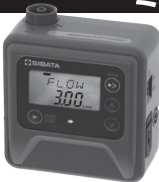
積算流量測定機能、定流量機能を内蔵した携帯型のアサンプリング用吸引ポンプです。設定流量範囲は0.050~5.00L/minと広範囲をカバーしており、個人ばく露測定や作業環境中のアサンプリングなど幅広く使用いただけます。
