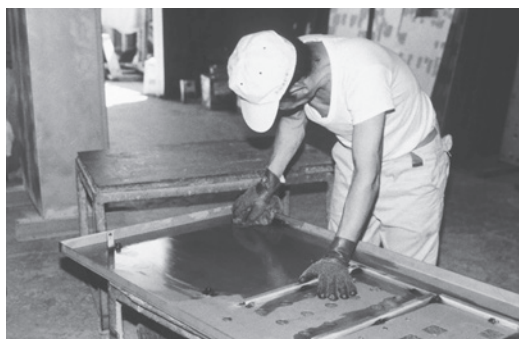
写真1 トルエンによる汚れの払拭
