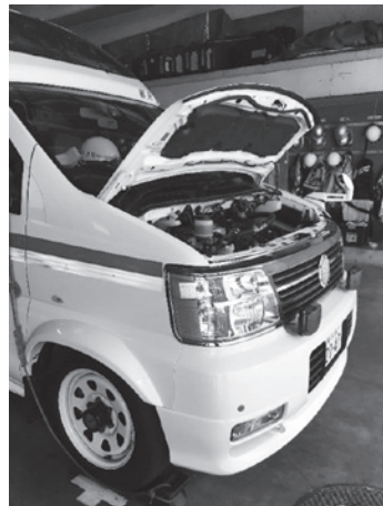
写真 高熱によるエンジン部品等の劣化防止のため盛夏中はガレージでボンネットを開けて待機する救急車
