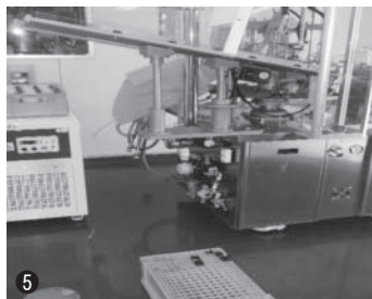
⑤肘が高いチューブ充填機の作業姿勢改善のために踏み台を設置
