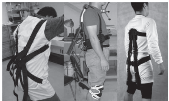
図2 機能試作 (左より, ①平ゴムバンドタイプ, ②フレーム付ゴムバンドタイプ, ③弾性板タイプ)
