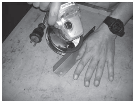
事例3 危険予知不足の事例
