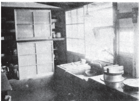
図2 改善後の農業労働調査所の台所 (上) 南側：左手奥に七輪台、その上に鍋棚、その右側に調理台が見える (下) 北側：手前から竈、流し、水槽。ガラス窓の下に配置されて、十分な明るさが確保されている
