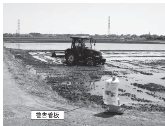
図10 乗用トラクタロボットの代かき作業風景と警告看板
