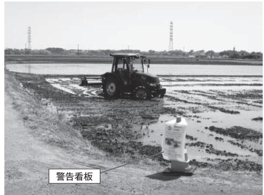
図7 乗用トラクタロボットの代かき作業風景と警告看板
