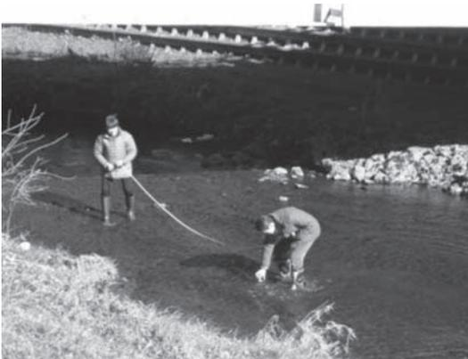
写真5 野川の定点観測（流量測定）
