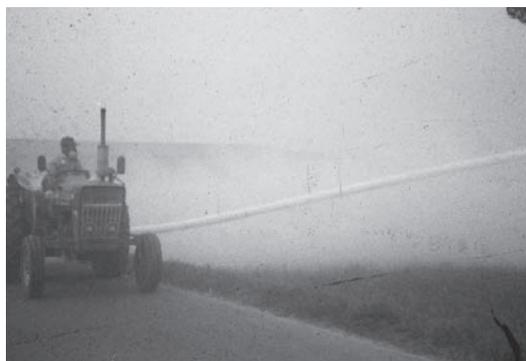
写真6 パイプダスターを用いた粉剤散布例
