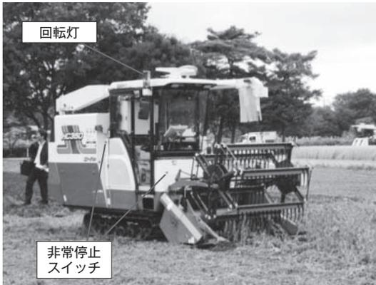
図6 コンバインロボットと安全装置
