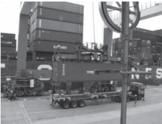
図5 トラクターがコンテナの乗ったシャーシ（台車）をコンテナヤードに運ぶ様子
