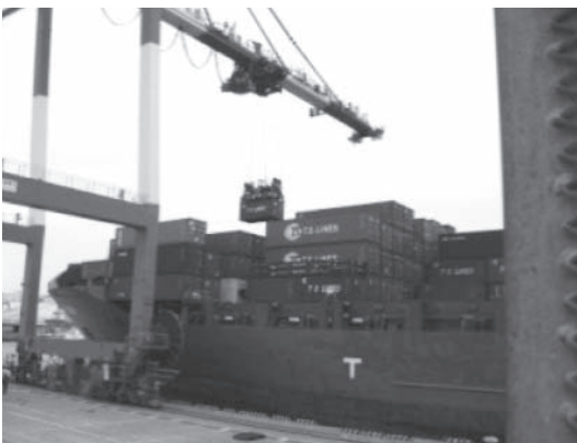
図3 コンテナの船積み、船卸しを行うガントリークレーン
