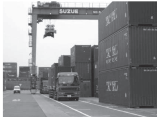
図6 トラクターが運んできたコンテナの積み上げを行うトランスター
