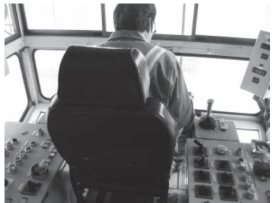
図4 地上約40mの高さにあるガントリークレーンの操縦席
