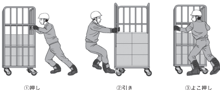
図5 ロールボックスパレットを例とした基本的な操作方法
